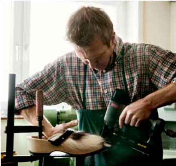
Marco klebt und klammert das Fellstück an den Holzschuh. Davor hat es sein Bruder Alexander in warmes Wasser getaucht (ganz oben), damit es noch weicher wird. An Werkzeug (oben) mangelt es nicht. Was man braucht, hat man gleich zur Hand.
